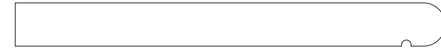
Gradone arrotondato con gocciolatoio . Rounded coping with drip Nez de marche arrondi avec goutte d'eau . Monolitische Stufenplatten mit Abtropfen
